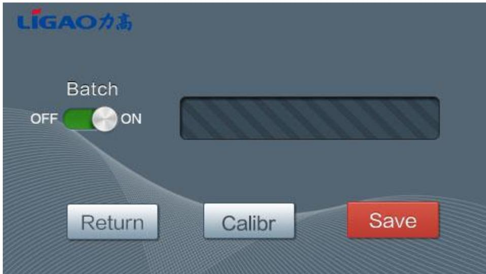
8 Batch: Batch 버튼을 클릭하여 설정화면으로 들어갑니다. 배치 모드 기능을 시작 및 중지하려면 "ON" 및 "OFF" 스위치를 클릭합니다. 필요한 누적 흐름 값을 설정합니다. 펌프는 누적 유량에 도달한 후에 정지합니다.
