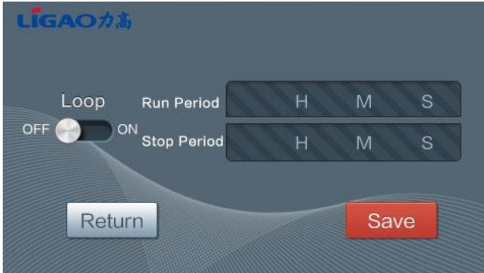
6 Loop: "Loop" 버튼을 클릭하여 설정화면으로 들어갑니다. 루프 모드 기능을 시작 및 중지하려면 "ON" 및 "OFF" 스위치를 클릭합니다. "실행 기간"은 한 사이클 동안의 펌프 작동 기간 시간입니다. 예를 들어, 2분. "정지 기간"은 1분과 같이 한 사이클 동안의 펌프 정지 기간 시간입니다. 저장 버튼을 클릭합니다. 펌프를 시동한 후 펌프가 2분간 작동하다가 1분간 정지하고 2분간 작동한 후 1분간 정지합니다. 이 주기는 계속됩니다. 이 기능은 로컬 작동 모드에서만 유효합니다.
